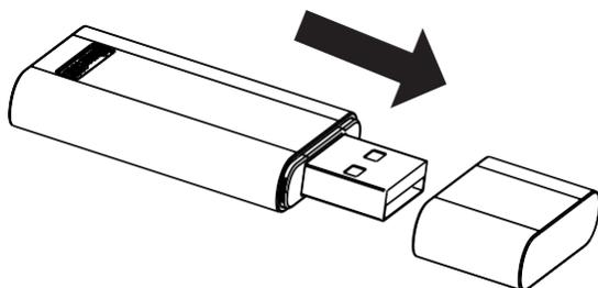
2) Ouvrez le panneau avant et insérez le kit intelligent dans l'interface réservée (pour le modèle A).
