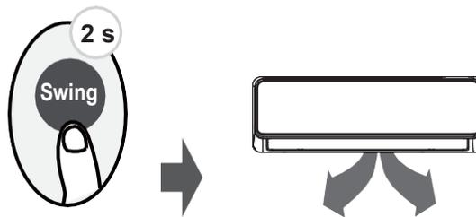
Maintenez ce bouton enfoncé pendant plus de 2 secondes, la fonction de basculement vertical du volet d'aération est activée. (Pour les unités avec dispositif d'oscillation vertical de volet)
