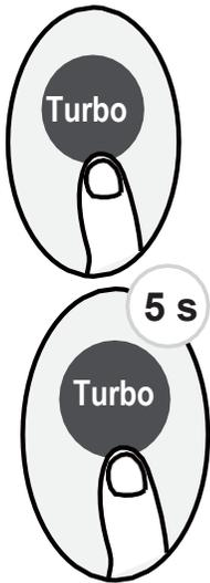
Lorsque vous sélectionnez la fonction Turbo en mode COOL (Froid), l'appareil souffle de l'air frais avec le réglage du vent le plus fort pour démarrer le processus de refroidissement.
