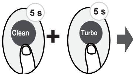
Appuyez simultanément sur les boutons **Nettoyage (Clean)** et **Turbo** pendant plus de 5 secondes pour activer la fonction de verrouillage. Aucun bouton ne fonctionnera, sauf lorsque vous appuyez à nouveau sur ces deux boutons pendant deux secondes pour désactiver le verrouillage.
