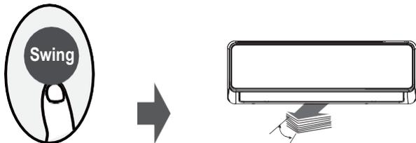
La grille d'aération horizontale pivote de haut en bas automatiquement lorsque vous appuyez sur le bouton Swing (Pivotement).
