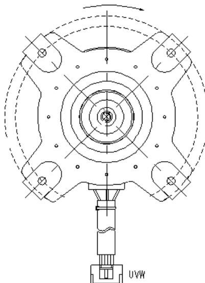
**2. Moteur de ventilateur CC intérieur (puce de contrôle est dans le moteur du ventilateur, vent. seulement)**
