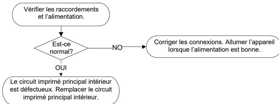
**Remarque :** L'erreur de détection du passage à zéro n'est valable que pour l'unité avec moteur à ventilateur CA; pour les autres modèles, cette erreur n'est pas valide.
