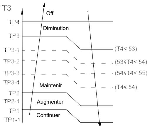
Le compresseur cesse de fonctionner lorsque la température du condensateur dépasse une valeur configurée.
