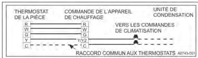
FIGURE 17 : Branchements du thermostat, chauffage monoétage
